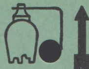
Anode = vorn liegende Schraubkappe
