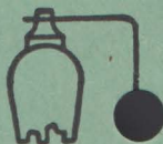
Gitter = hinten liegende Schraubkappe
